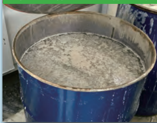
回収した石綿スラッジを保管 B
